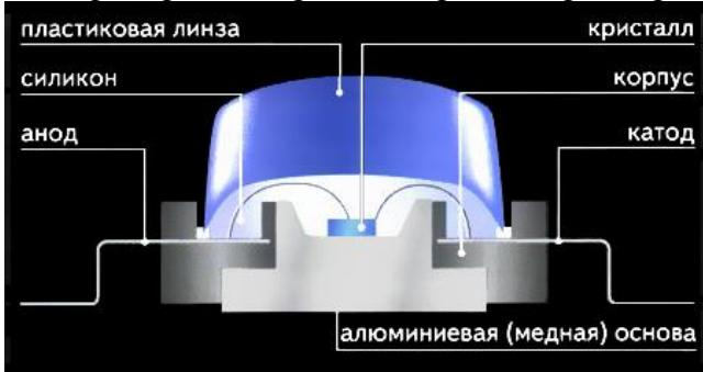
Работа светодиода основана на свойствах р-п или электронно-дырочного перехода, обусловленных взаимодействием двух полупроводников р-типа и п-типа: Р – positive, то есть положительный тип, или дырочный, и Н – negative, то есть отрицательный тип, или электронный. В результате пропускания электрического тока в месте соприкосновения двух полупроводников происходит переход от одного типа проводимости к другому, и мы видим излучение света.
